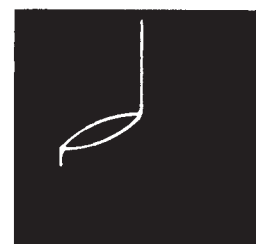
Transistor Emitter/Basis parallel mit 1µF + 680Ω
