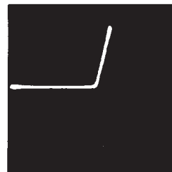
Diode in Reihe mit 51Ω
